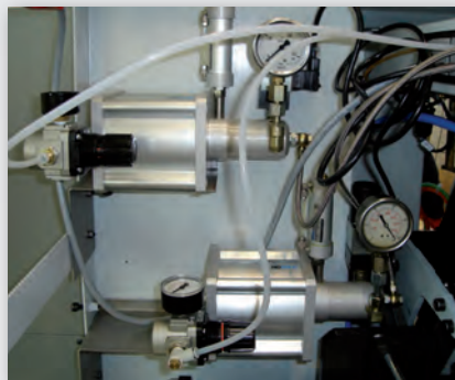
Moltiplicatori di pressione per macchine utensili CNC CNC machine's oil booster
