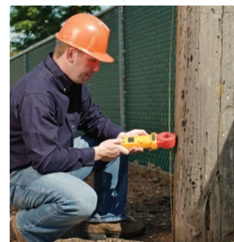
ES-162P3-2 Zestaw elektrody/szpuli kabla do pomiarów 3-biegunowych dla 1621
