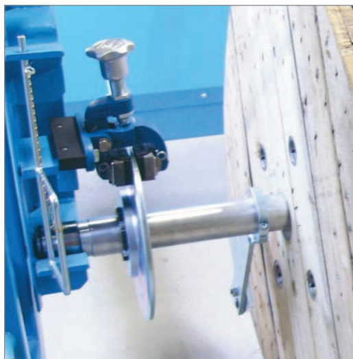
TROMROL z hamulcem tarczowym i zaciskiem hamulca
