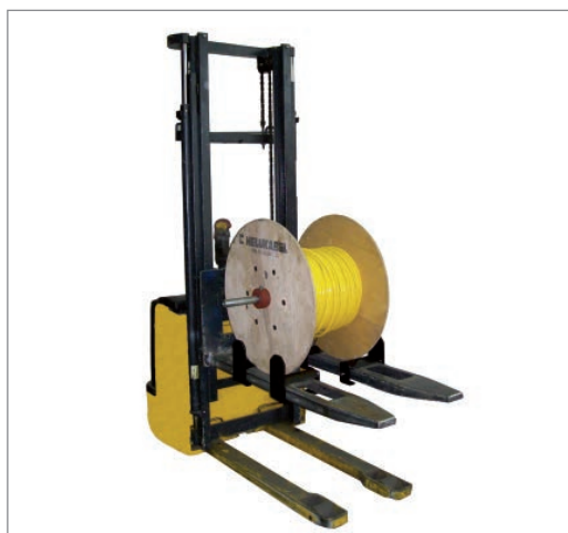
TROMSTOP do bezpiecznego transportu po zamontowaniu na wózku widłowym.
