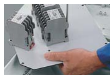
Montaż aparatury na płycie montażowej
