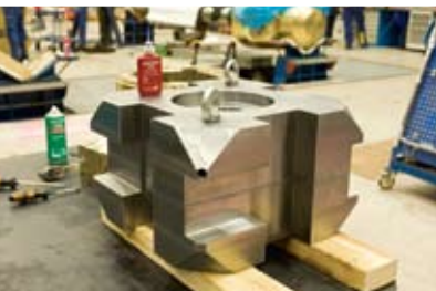
Loctite® 243 – zabezpieczenie mechanizmu sterującego śruby napędowej
