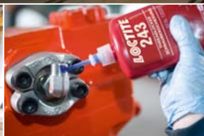
Te mocowanie gwintowe musi znieść ciśnienie oleju sięgające 350 bar
