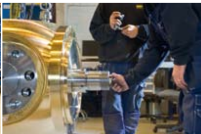
Mocowanie cokołu na piastę wału przy pomocy Loctite® 243
