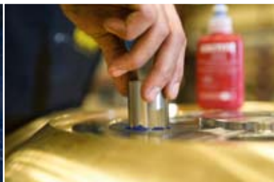
Kołek ustalający mocujący skrzydła śruby napędowej zabezpieczony Loctite® 243
