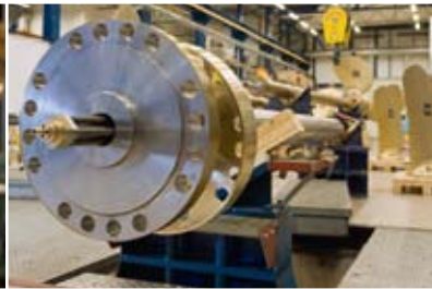
Montaż systemu hydraulicznego we wnętrzu wału
