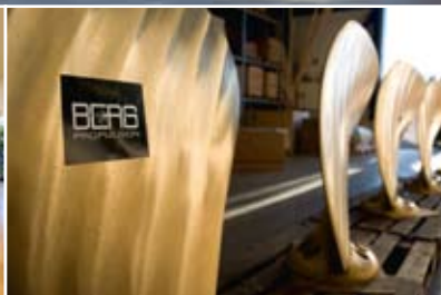
Skrzydła śruby napędowej gotowe do montażu
