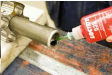
Zabezpieczenie i uszczelnianie gwintów przy pomocy jednego produktu – Loctite® 638
