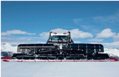
Masywny, zasilany hydraulicznie spychacz o szerokości 7,1 metra
