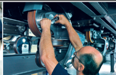
Mocowanie kół kolejkowe, śruby są zabezpieczone przy pomocy Loctite® 243
