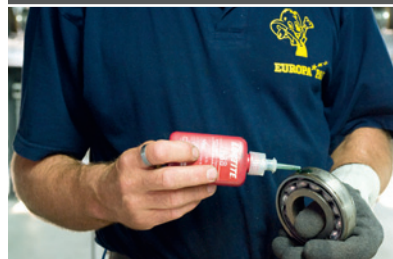
Nakładanie wstęgi kleju mocującego Loctite® 638 na zewnętrzną bieżnię łożyska kulkowego
