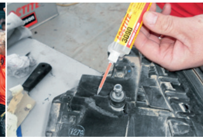
Naprawa połamanej mocowania lampy przedniej przy pomocy Loctite® 3090
