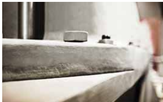
LOCTITE SI 5980 doskonale uszczelnia złącza kołnierzowe dmuchawy próżniowej.
