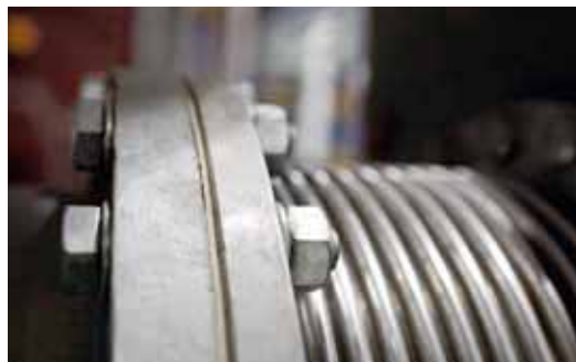
Smar LOCTITE 8150 anti-seize chroni śruby mocujące dytatację w rurze wydechowej.
