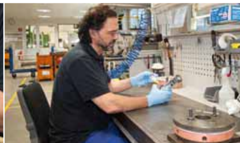
Montaż pianki poliuretanowej z aluminium przy zaworze obrotowym. Klejone za pomocą LOCTITE 406.
