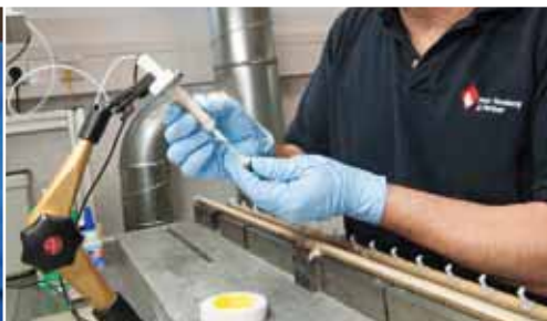
LOCTITE 406 aplikuje się za pomocą pompy perystatycznej, aby skleić poliamid i mosiądz przy rurze opadowej.
