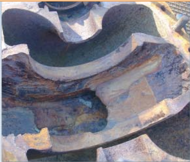
Rys. 1: Widoczna korozja i erozja
