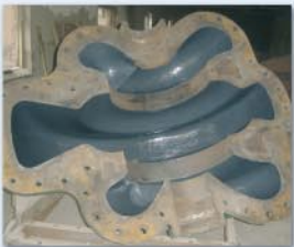
Obudowa po naprawie.
