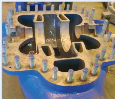
Rys. 4: Cała powierzchnia wewnątrz pompy zabezpieczona podwójną warstwą
