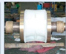
Naprawa zużytego i skorodowanego wału przy użyciu Loctite® 3478 Superior Metal, po utwardzeniu należy poddać go obróbce mechanicznej. Wszystkie elementy należy zabezpieczyć przy pomocy Loctite® Nordbak® 7228 Brushable Ceramic White (posiada certyfikat dopuszczający do kontaktu z wodą do picia)
