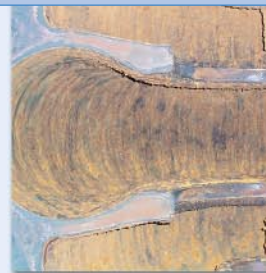
Pokrywa i wirnik wykonany z brązu przed naprawą. Pierwszy krok to obróbka strumieniowo – ścierna do profilu 75 µm i klasy Sa 3.
