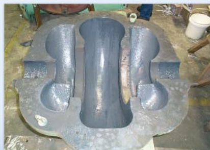
Szara powłoka ceramiczna Loctite® Nordbak® 7227 Brushable Ceramic została naniesiona w celu zabezpieczenia powierzchni. Skorodowane i wyżarte obszary należy wypełnić Loctite® Wear 7222 Resistant Putty.
