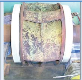
Pokrywa i wirnik wykonany z brązu przed naprawą. Pierwszy krok to obróbka strumieniowo – ścierna do profilu 75 µm i klasy Sa 3.
